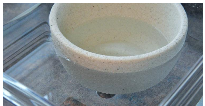
In ein Wasserbad gelegt, lässt die Haube innerhalb kurzer Zeit Wasser eintreten und geht schließlich sogar unter.
