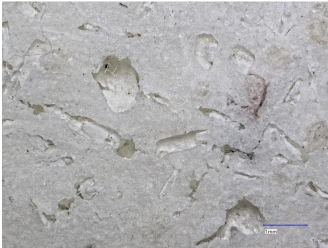
Mikroskopische Hochkontrast-Aufnahme von Porosium® mit 40-facher optischer Vergrößerung.
